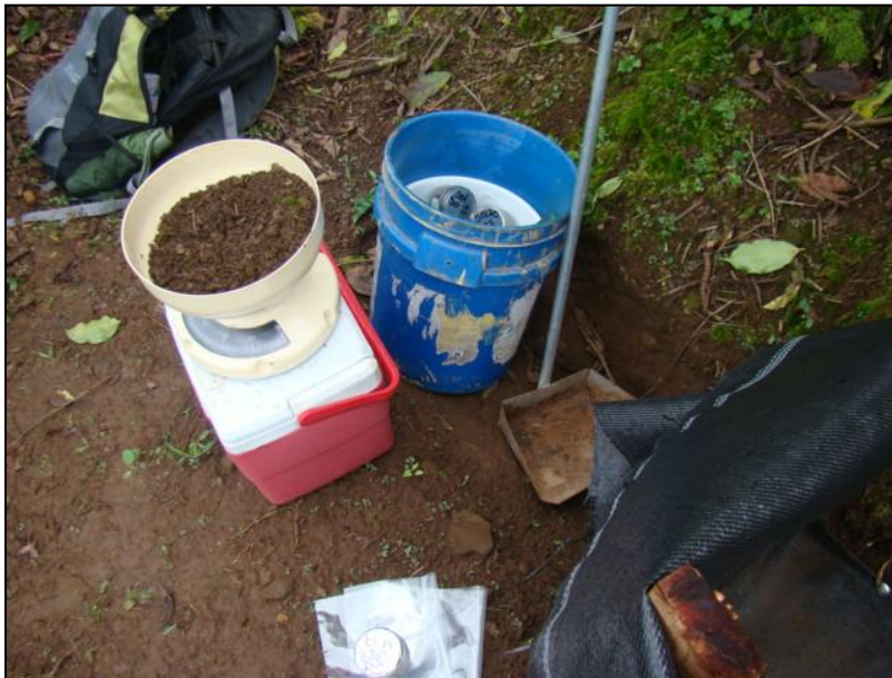
Figura 20. Fotografía de los materiales utilizados para la recolección semanal de sedimentos. Maletín con planillas para la toma de datos, balanza gravimétrica, pala de recolección de sedimentos, latas para las muestras de humedad gravimétrica y una hielera para su almacenaje, bolsas plásticas para las submuestras de fertilidad y textura y un balde multiuso.
