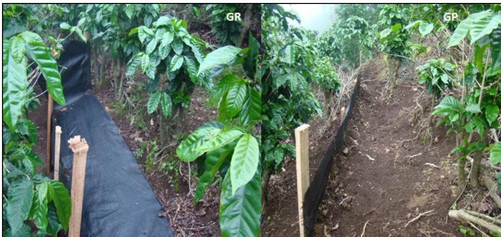
Figura 11. Fotografías del geotextil de recolección (GR) y geotextil de protección (GP) en una microparcela de erosión utilizada para la cuantificación de pérdida de suelo en un área de 21 m 2 correspondiente al área de muestreo CSS-30+AG.
