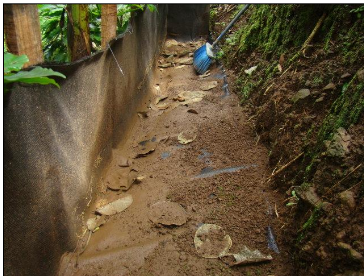
Figura 31. Fotografía del geotextil de recolección en el área de muestreo CMS-60+A, tomada en setiembre del 2013.
