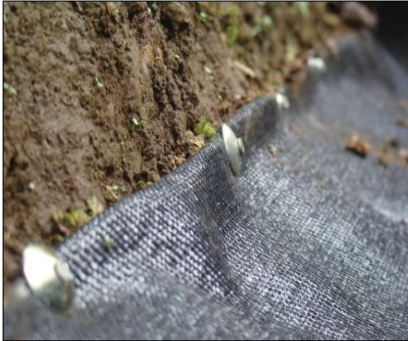
Figura 18. Fotografía del geotextil de recolección con clavos de arandela ancha correspondiente a una microparcela de erosión de 21 m 2 en un área de muestreo de CSS-60+AG.
