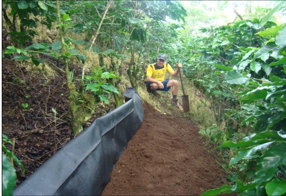
Figura 14. Fotografía que indica cómo acomodar el geotextil de recolección en la fosa de excavación correspondiente a una microparcela de erosión de 21 m 2 en un área de muestreo de CLS-60+A.
