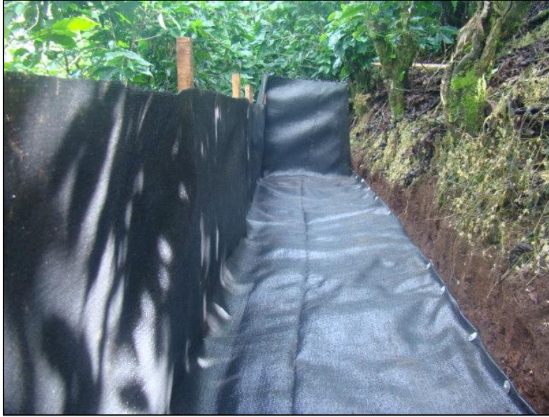
Figura 16. Fotografía que indica cómo ajustar el geotextil de recolección a las estacas de 1,20 m correspondiente a una microparcela de erosión de 21 m 2 en un área de muestreo de CLS-60+A.
