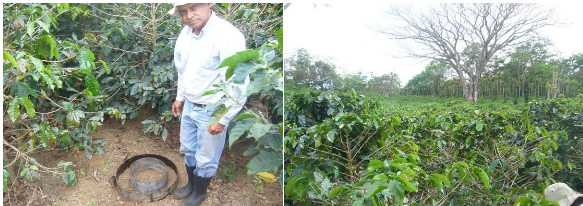
Foto 8. Prueba de infiltración en suelo 2 con café bajo sombra: parte alta de la cuenca del Río Jesús María
