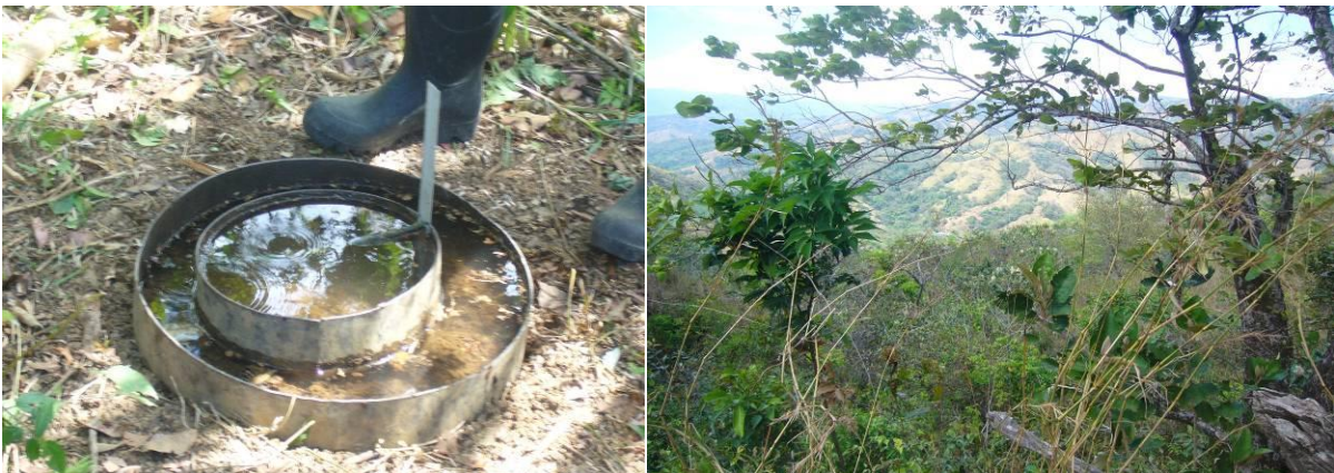
Foto 7. Prueba de infiltración en suelo 3 con bosque secundario: parte alta de la cuenca del Río Jesús María
